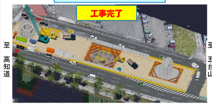
作業土工(床掘)
